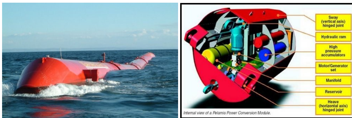
Figura 22 Pelamis in funzione. A destra spaccato di un caratteristico modulo interno
