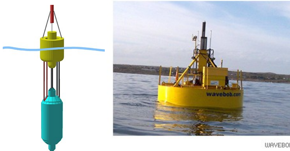
Figura 21 Wavebob point absorber. A sinistra disegno grafico, a destra il Wavebob durante i test in mare
