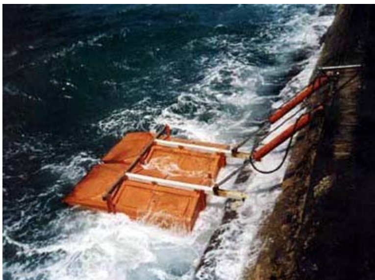
Figura 5 Immagine di un modulo di conversione di energia in scala reali durante i test in Israele
