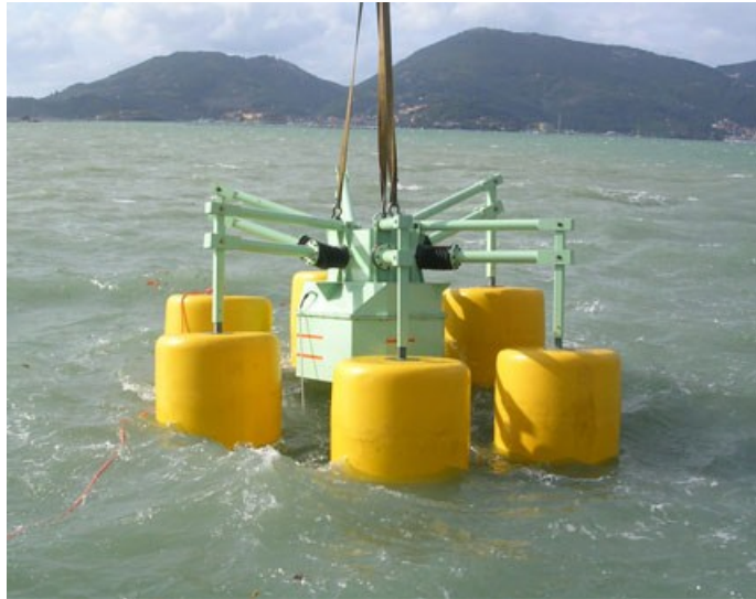
Figura 9 WEM. Test in mare di un singolo modulo
