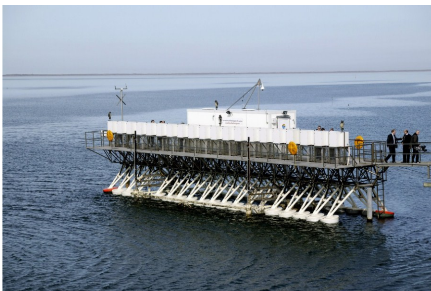
Figura 16 Sistema Wavestar durante i test in scala 1:2
