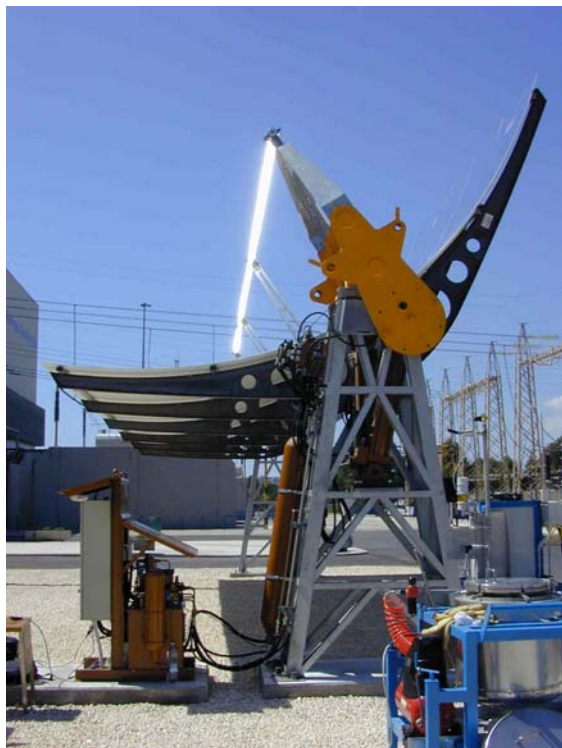
Fig. 21 - Sistema di movimentazione dei collettori
