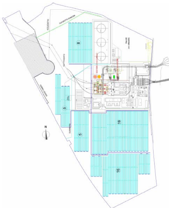
Fig. 39- Schema della disposizione dei collettori solari (in celeste) sull'area disponibile
