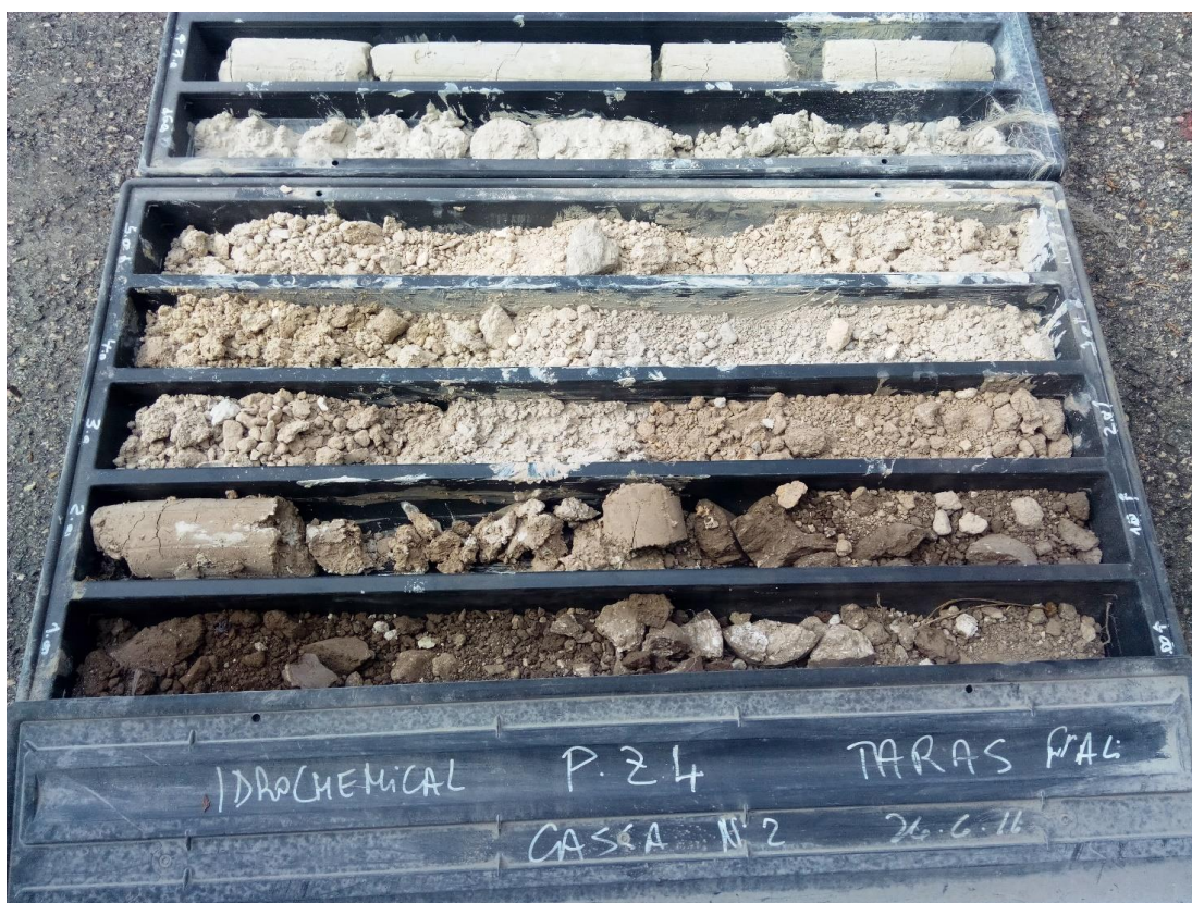
Figura 3.4: carota di terreno estratta nell'installazione del piezometro PZ4
