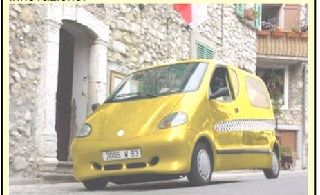
L'automobile cammina grazie a delle bombole di aria compressa che alimentano un motore MDI di 567cc da 25 CV. Il motore non funziona a combustione ma semplicemente grazie alla espansione dell'aria compressa.
