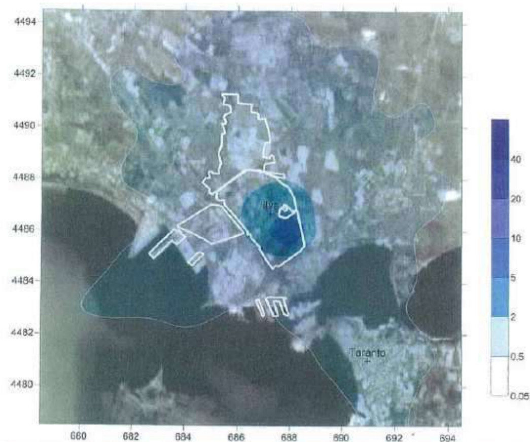
Figura 31. Dettaglio della mappa di deposizione totale al suolo medie annue di diossine su un'area 15x15 km 2 centrata sullo stabilimento ILVA. Valori in pg(TEQ)/(m 2 giorno) secondo la scala colorata riportata a destra del grafico
