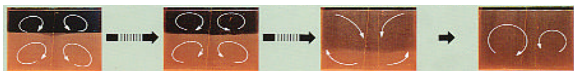
Fig. 10.6 - Schema esplicativo della dinamica del rollover .
