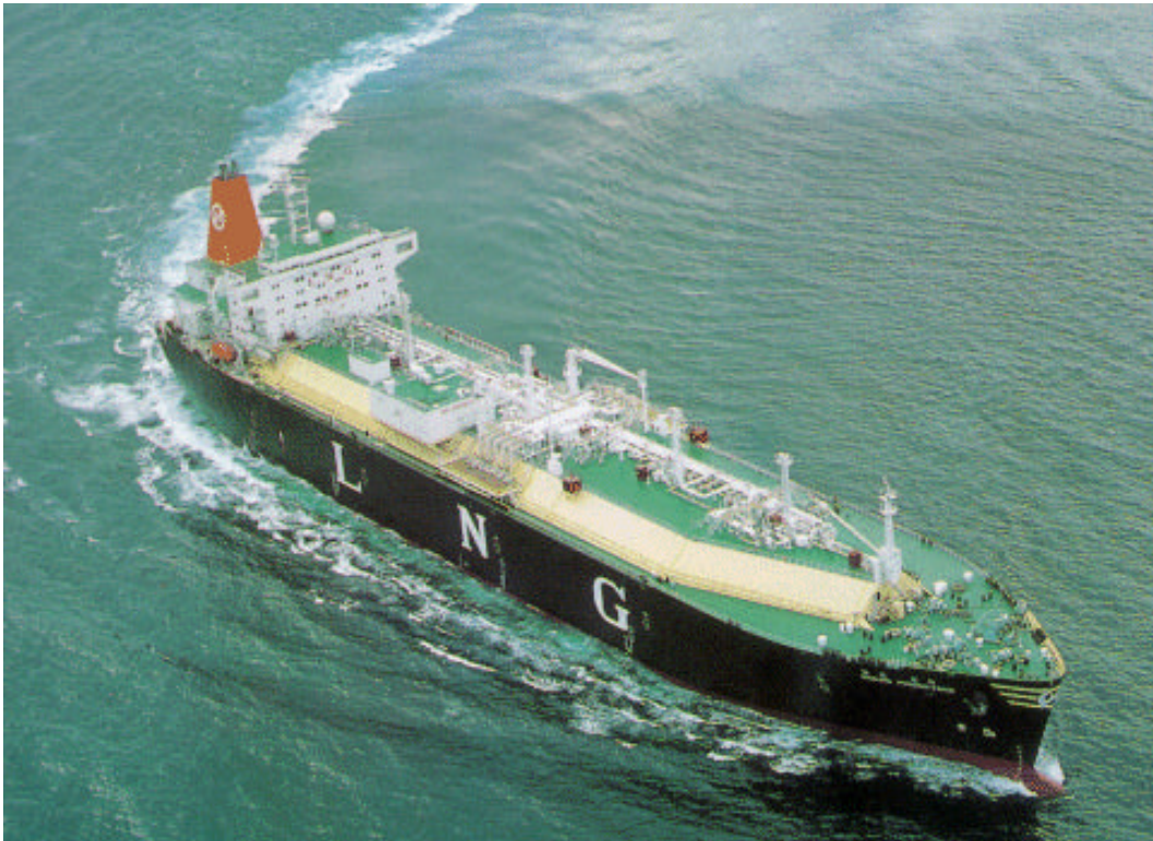
Fig. 8.1 - Esempio di nave metaniera con serbatoi prismatici a membrana (tecnologia Gaztransport-Technigaz).
