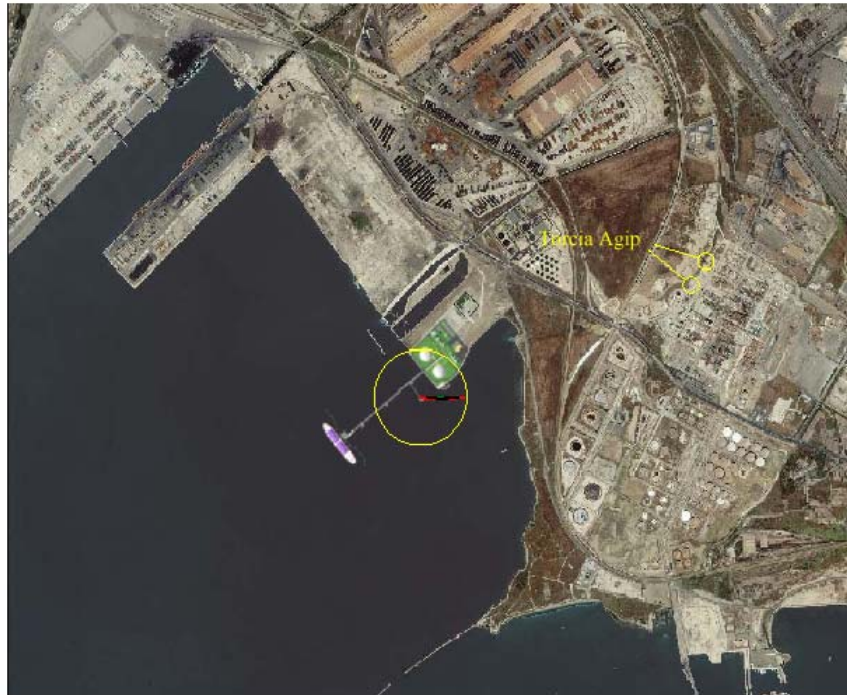
Dispersione in atmosfera e limiti di infiammabilità LEL dei vapori di GNL
